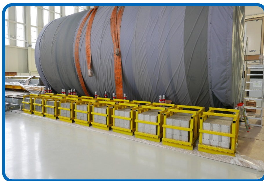
Рис. 8. Доставка и хранение модулей переднего адронного калориметра FHCAL в экспериментальном зале MPD.
